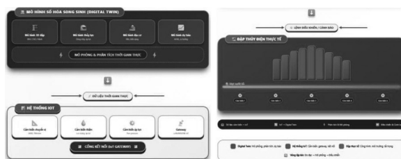
Hình 3. Kiến trúc tích hợp IoT và Digital Twin trong giám sát đập
